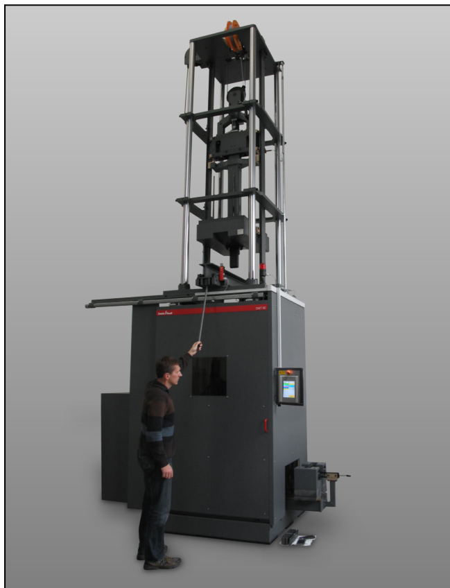
ZwickRoell Großfallwerk DWT60 mit 2,5 m Fallhöhe
